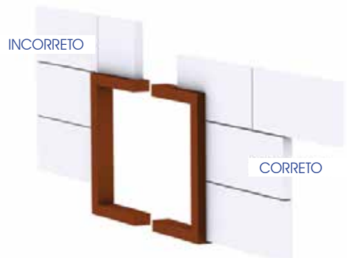
Figura 85 - Pormenor de colocação das placas nos vãos
