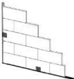
Figura 84 - Assentamento alternado de placas Melhora o travamento do sistema, incluindo nos cantos
